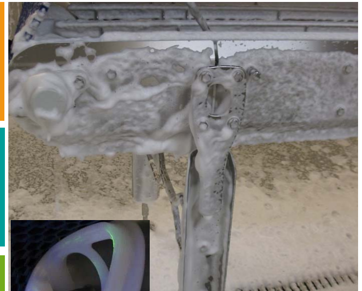
Test av rengöring samt kontroll med hjälp av UV-ljus. Foto: SP Food and Bioscience
